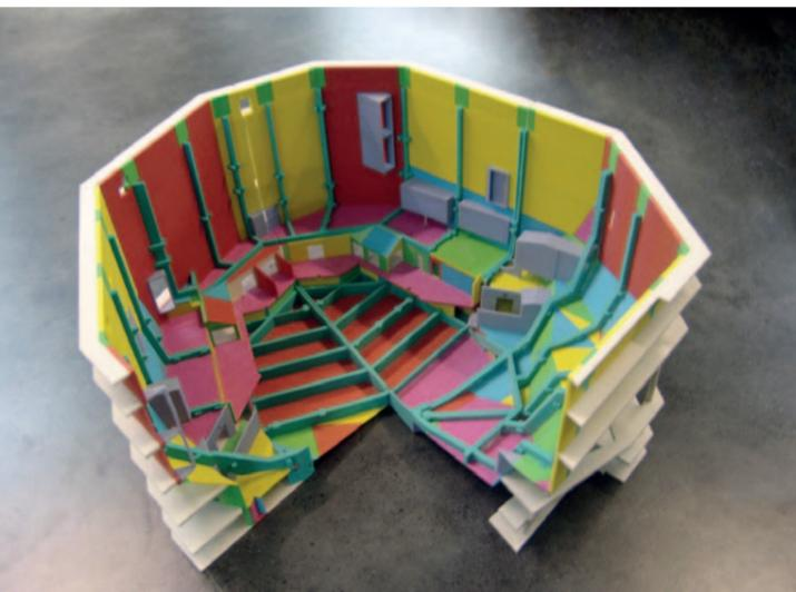
**Anwendung von 3D-Modellen im Bauprozess: Der Konzertsaal der Hamburger Elbphilharmonie besteht aus vielen, räumlich verwinkelt angeordneten, teilweise schief im Raum liegenden Teilflächen und Zugängen. Ein mittels 3D-Druck hergestelltes farbiges Modell aus Polymergips (unten) konnte die komplexe Bauausführung vereinfachen. Die Farben des Modells dienen als Referenzflächen beim Einbau der verschiedenen Ebenen im Konzertsaal.**
